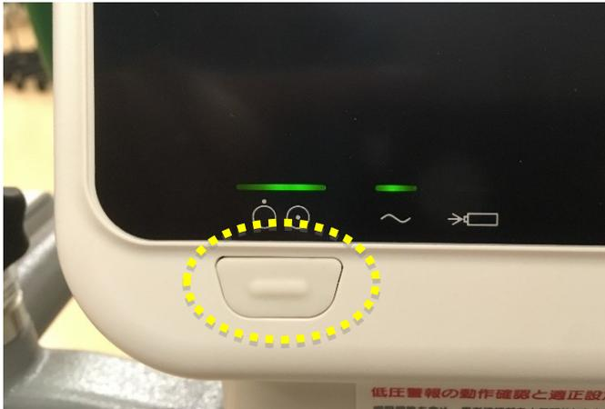
前面左下のパイロットランプが緑色に点灯している事を確認し、「ボタン」を押し電源を入れる。
