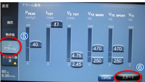
⑥スタートをタッチすると、先程と同様に「接続を検知すると換気を開始します」の表示になるので、患者に接続、もしくはテストラングに接続し動作を確認する。
