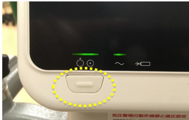
その後、本体左下の「電源ボタン」を押すと、シャットダウンダイアログが表示されるので、シャットダウンを選択すると電源が切れる。
