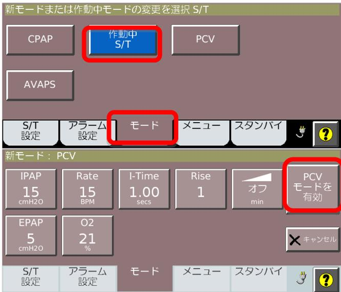
モードを変更する場合には、モードのタブをタッチし選択できるモードを表示させる。(現在使用しているモードは青表示で作動中と表示されている。)
