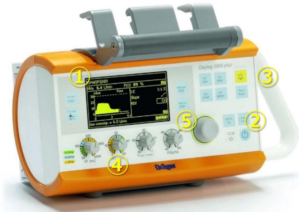
1.画面および各部名称:①ディスプレイ ②電源スイッチ ③アラームインジケータ、消音ボタン ④設定調整ノブ(一回換気量、呼吸回数、圧力制限アラーム、FiO2) ⑤決定ロータリーノブ
