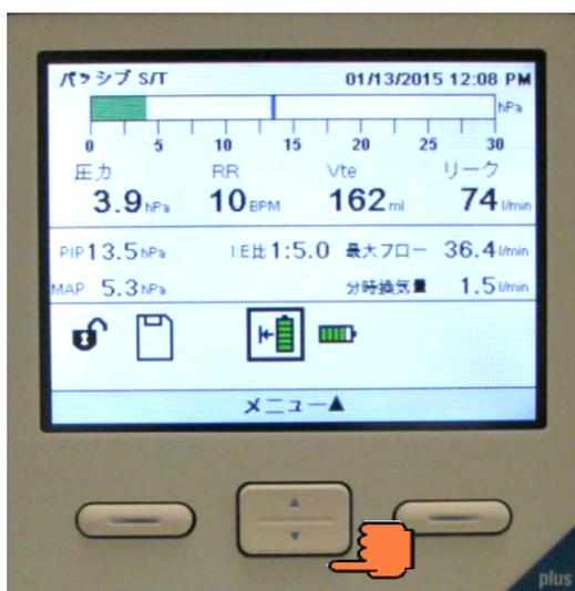
画面下部に「メニュー▲」の表示がありますので、上下ボタンの上を押します。※画面下部に「メニュー▲」の表示が無い場合には、キーパッドロック機能がONになっています。解除するためには、いずれかのボタンを押すと「解除するには右のキーを5秒間押し続けます」というウィンドウが開きますので、この状態で右ボタンを5秒以上押してください。「ピッ」という電子音とともに画面下に「メニュー▲」が現れます。
