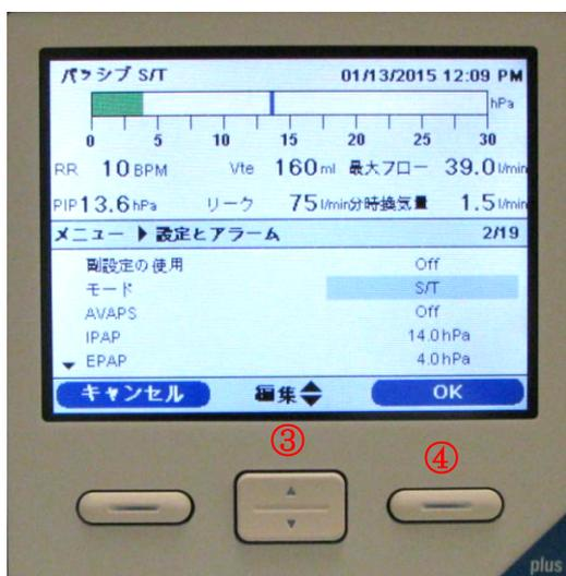
③上下ボタンでモードの切り替え、On/Offの切り替え、数値の増減が出来ます。④調整が終わったら、右ボタンのOKを押します。これで、設定が変更されました。他の項目についても変更したい場合には①から④を繰り返してください。全ての操作が終わったら、左ボタンの終了を押すと、メニュー画面に戻ります。
