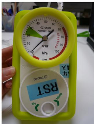
カフ圧チェッカーはダイヤル式となっており、微調整が可能である。また、付属のチューブにクランプがついているため、カフ圧の内圧を上げてから接続することができる（図 1）
